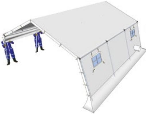
8. Befestigen Sie die Dachplane mit den vorgesehenen Schlaufen am Gerüst. Fixieren Sie die Pfosten mittels der Erdnägel.
