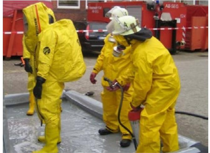
**Aufblasbares Dekontaminationsbecken** für Katastrophenschutz, Rettungsdienst und Feuerwehr zum schnellen Einsatz für die Säuberung von Personen und Geräten geeignet. Das Dekonbecken kann sowohl mittels Gebläse als auch mittels Pressluftflaschen schnell und einfach aufgeblasen werden.
