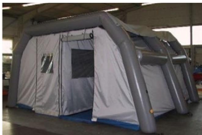
Kundenspezifisches Spezialzelt als **mobile Bio-Labor-Einheit**, leicht, luftverlastbar, schnell aufzubauen mittels Elektrogebläse und mit wandelbarer Innenraumeinteilung. Die Kabine kann vom Rahmen abgenommen werden, um das Zelt auf 2 Packstücke zu verteilen. Kann auf Wunsch auch für Unter- oder Überdruckbelüftung nachgerüstet werden.
