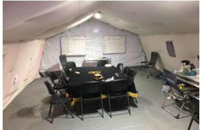
**Doppeldachzelte** werden von Hilfsorganisationen besonders in Regionen mit extremen Klimaschwankungen eingesetzt. Der Luftspalt von 10 cm zwischen Außen- und Innenzelt sorgt für eine besondere Dämmung gegen Kälte bzw. Hitze. Der fest am Innenzelt angenähte PVC-Boden (Option) bietet Schutz vor Insekten. Die Außenzeltplane gibt es entweder als Baumwoll-
