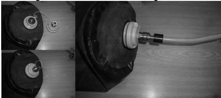
Abbildung Nr. 7 – Druckflaschenbefüllung mit dem AH Ventil
