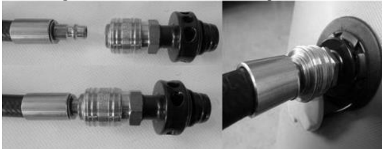
Abbildung Nr. 6 – Druckflaschenbefüllung mit dem C7 Ventil
