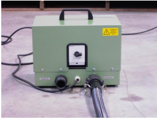
Turbogebälse mit Saug- / Druckseite und Einschalter (Stellungen „0“, „1“ und „2“)
